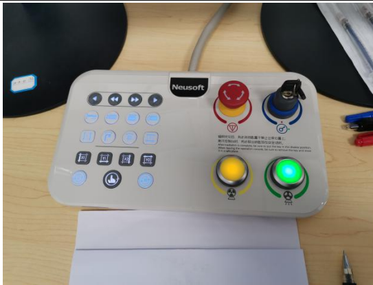
治疗室门与束流联锁（门-机联锁）装置
